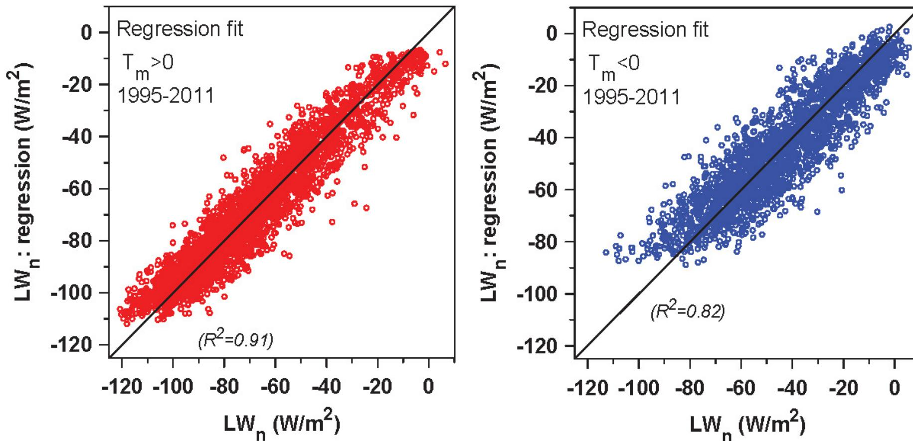
**Warm:** LW<sub>n</sub> = -128.6(±7.8) + 28.1(±1.8)OPAQ<sub>m</sub> + 44.6(±1.8)OPAQ<sub>m</sub><sup>2</sup> + 0.49(±0.01)RH<sub>m</sub>
